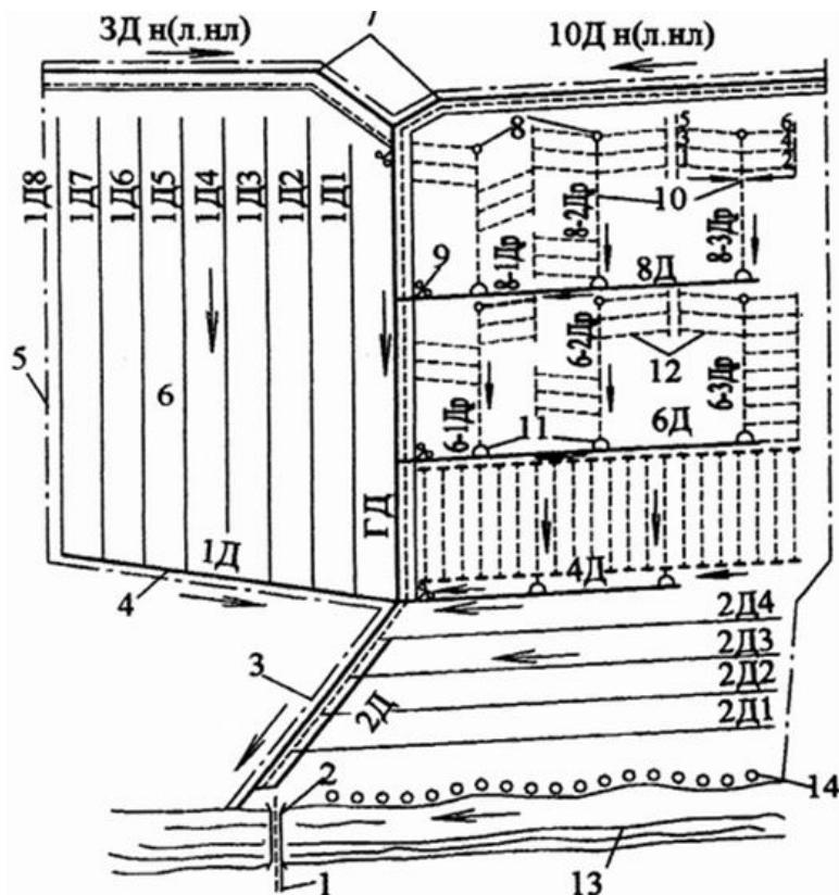
4. Способ осушения при ускорении поверхностного стока:
